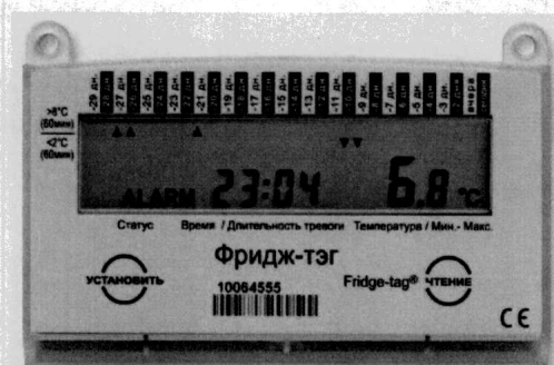
Рисунок 2 - Общий вид термоиндикаторов регистрирующих автономных Q-tag (Кью-тэг) с датчиком температуры модификации Fridge-tag (Фридж-тэг)
